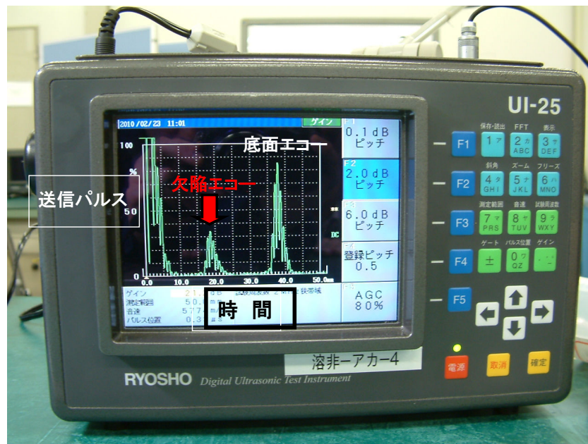
垂直探触子の場合の欠陥信号例
