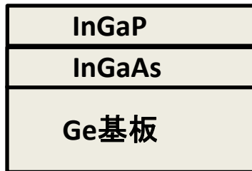
InGaP/InGaAs/Ge 三接合太陽電池
