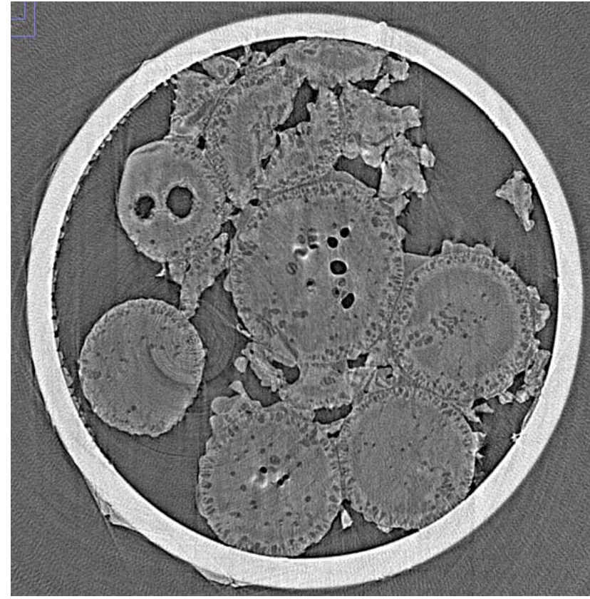
G25 緩速凍結後に昇温(約-8°C)
