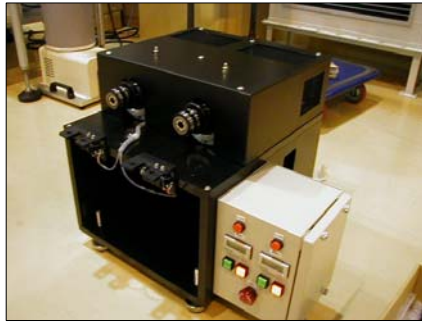
図2 回転曲げ疲労試験機（ビームライン横で使用）
