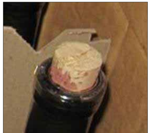
写真2 コルク栓の持ち上がり
