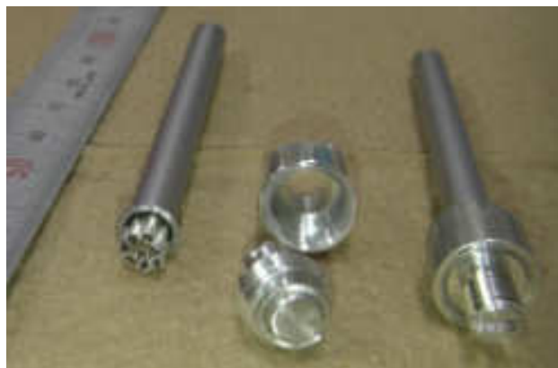
サンプル 8mmφ×50mm のバナジウム筒 に充填する
