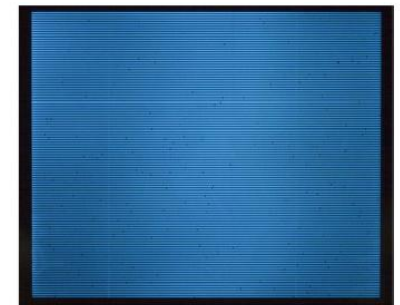
ボトムエミッション型2 inch, QCIF, AM-OLEDパネルの試作
