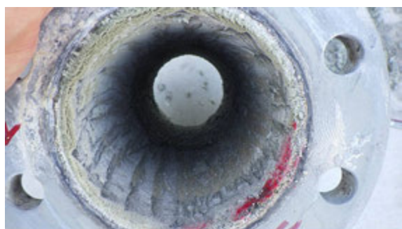
Fig. 1. サンプル直後の配管スケール Fig. 2. 温泉水で満たした観察容器内の温泉スケール
