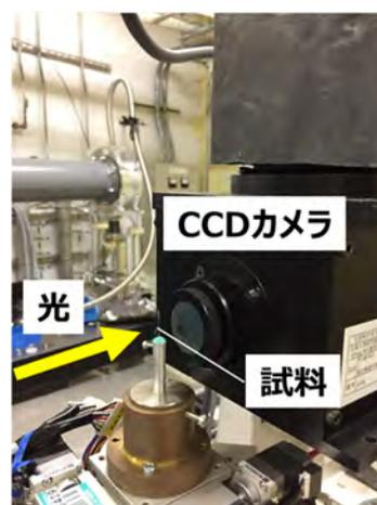
図 2. X 線 CT 測定の配置
