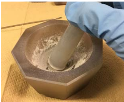
図 2 乳鉢での試料と窒化ホウ素攪拌の様子
