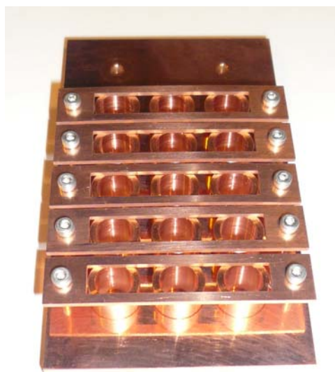
図 試料ホルダ(3列×5個)への試料取り付け例
