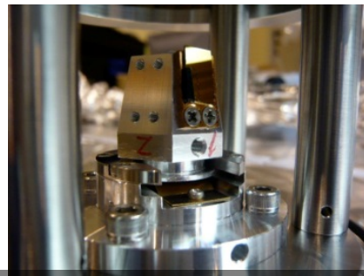
試料ホルダーをトランスファー ベッセルに格納した様子
