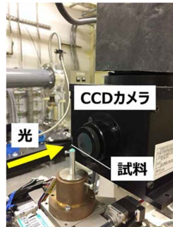
図 2. X 線 CT 測定の配置
