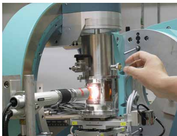
図 1 作成した多軸回折計へのマウント可能な液体窒素冷却試料ホルダーの設置状況。本実験ではホルダを透過配置でのみ利用した。
