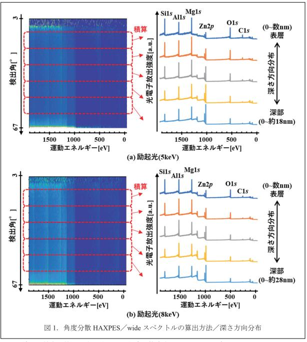
その結果、最大の検出深さが約 20 nm 程度と推定される 5 keV の場合、Si 1s、Mg 1s、O 1s、C 1s は酸化膜の表層が最大であり、Al 1s は中層で最大となり、Zn 2p は深部で最大となる。これに対して、8 keV の場合、O 1s と C 1s が酸化膜の表層で最大となり、Si 1s、Al 1s、Mg 1s は中層で
