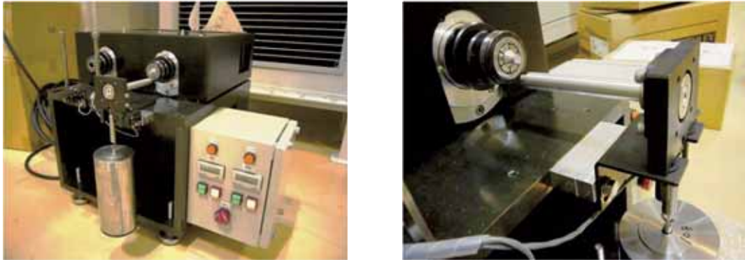
図3 回転曲げ疲労試験機の外観(左)と試験片破断後の様子(右)
