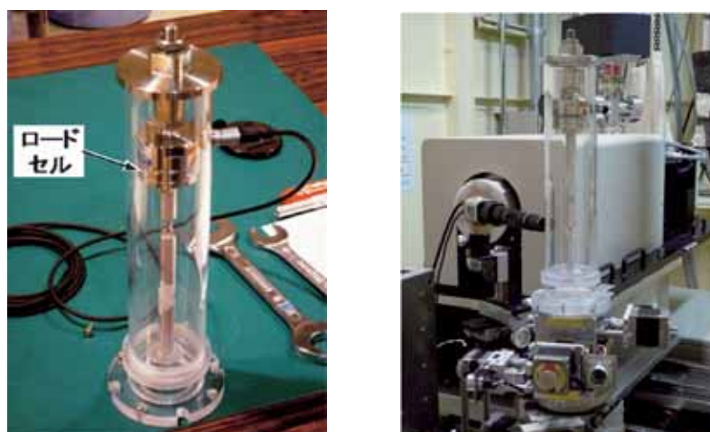
図 2 改良した試験片ホルダー(左)とゴニオメータへの設置の様子(右)
