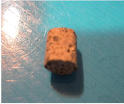
写真1. コンクリート小片供試体
